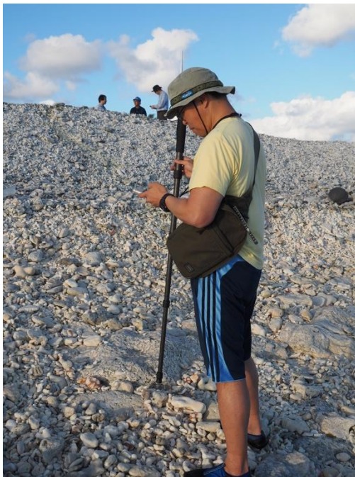
図2 RTK-GNSS による地形測量
