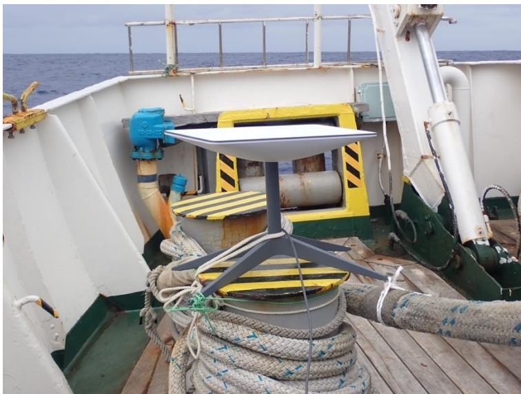
図 11 STARLINK のアンテナ，ルーターとバッテリー．ルーターは，右下写真のようにアンテナとのケーブルを介して室内に引き込むことができる．
