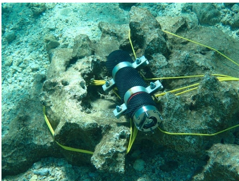
図 7 水中カメラの設置状況
