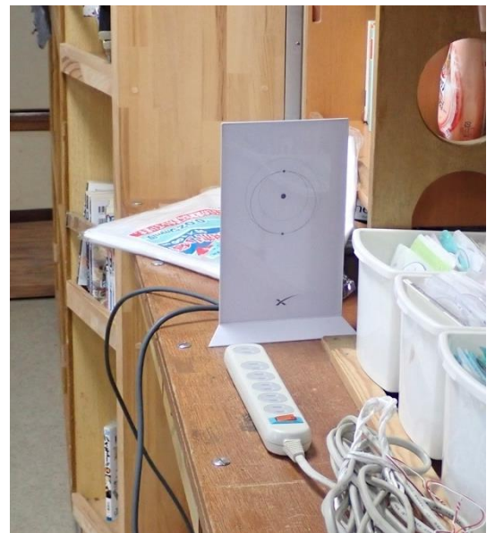
図 11 STARLINK のアンテナ，ルーターとバッテリー．ルーターは，右下写真のようにアンテナとのケーブルを介して室内に引き込むことができる．
