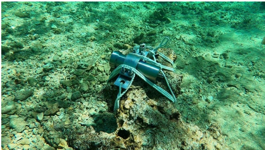
図 6 水圧センサの設置状況
