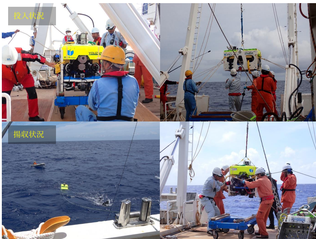
写真 3-2 「YOUZAN」投入揚収状況
