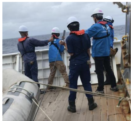
（図33）XCTD_1206での投入の様子
