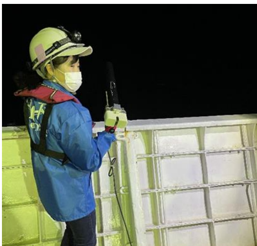
（図32）XCTD_1205での投入の様子
